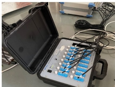
(c) 动态信号采集仪 图 9 试验现场照片 Fig. 9 Photographs of the test site
