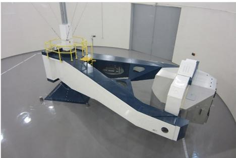
图1 ETC公司研发的ATFS-400-25载人离心机
