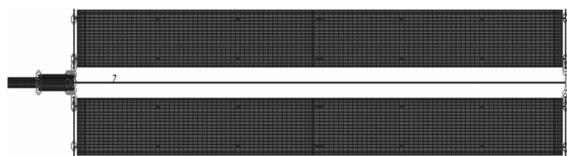
图4 柔性电池翼有限元模型
