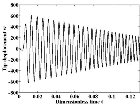
图7 机翼端点的波形图
