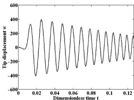
图5 机翼端点的波形图
