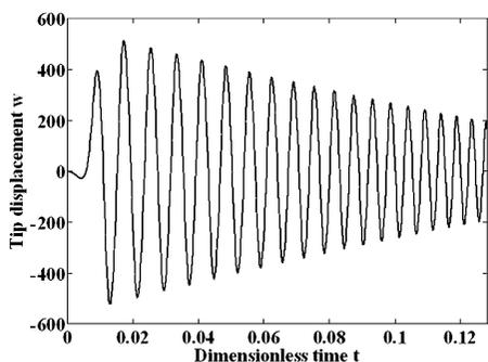
图6 机翼端点的波形图
