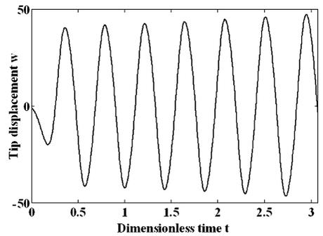
图 2 机翼端点的波形图
