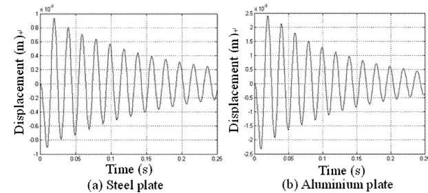
图 5 四边简支加肋平板中点的时域响应
