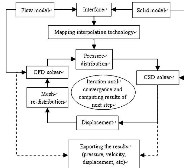
图1 CFD/CSD算法流程图
