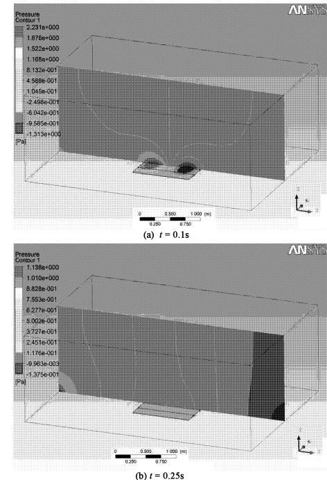
图 6 四边固支加肋平板压力分布云图
