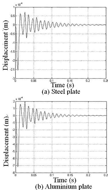
图7 四边固支加肋平板中点的时域响应
