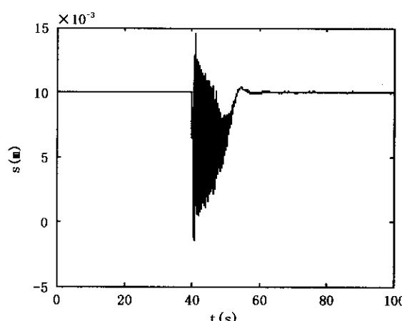
图 3  $K_P$  随质量的变化自动进行调整, 悬浮质量突然减小 15 % 时的系统阶跃响应
