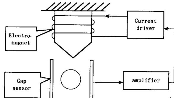
图 1 磁悬浮系统示意图
