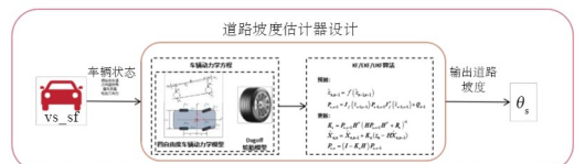
图 3 道路坡度估算技术路线
