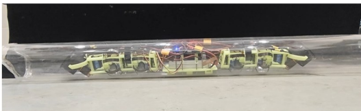
图 13 装配完的样机实物图 Fig. 13 Assembled prototype
