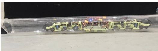
图 14 机器人在管道中爬行 Fig. 14 Robot crawling through a pipe
