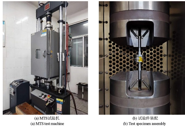
图 4 耗散特性试验设备及装配
