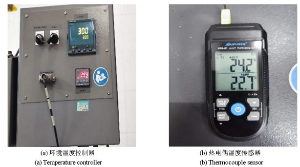
图 5 环境温度控制器及热电偶传感器
