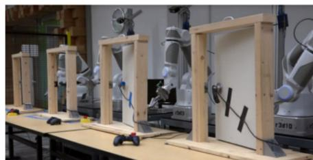
图 4 机器人通过异步训练学习开门动作<sup>[61]</sup>
