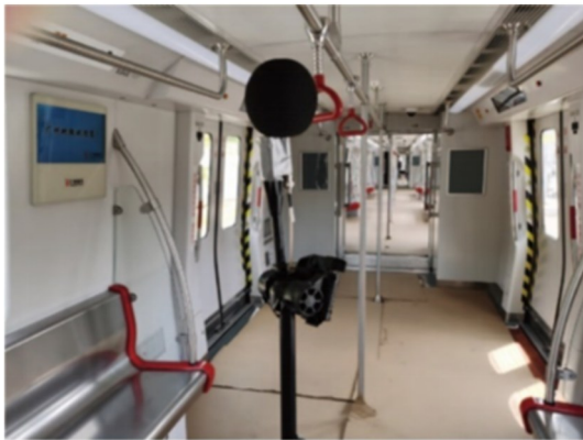
图 11 地铁实车振动测试现场
