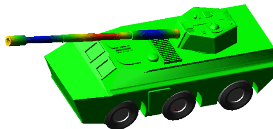
图2 组装后的刚柔耦合整车模型
