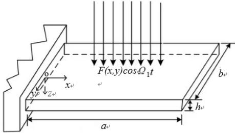
图2 压电纤维复合材料悬臂板的动力学模型
