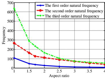
图4 不同长宽比下的压电纤维复合材料悬臂板前三阶固有频率
