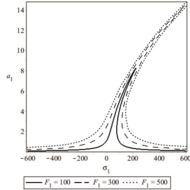
图5 一阶外激励作用下的幅频响应曲线
