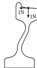
图2 名义接触点处施加单位径向/轴向力
