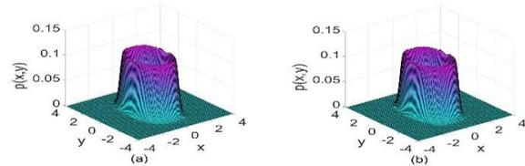
图7  $D_1=D_2=0.4, D_3=0.2$ 时未控系统关于广义位移与速度的联合概率密度.系统其他参数同图1
