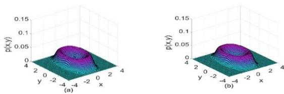
图5  $\omega_i=2.5$ 时未控系统关于广义位移与速度的联合概率密度.
