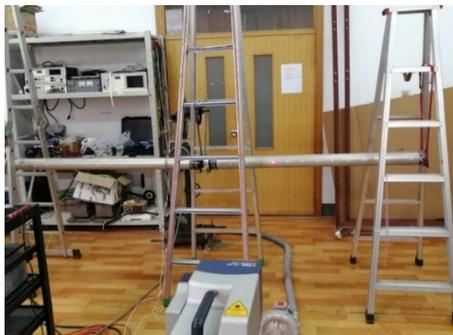
图3 尾传动轴系的模态试验
