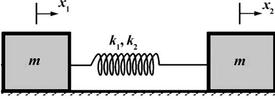
图1 线性、非线性刚性连接的两质点动力学模型
