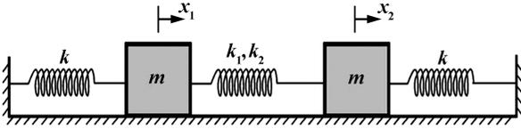
图2 具有固定边界的两质点动力学模型
