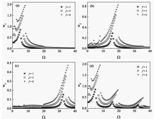
图6 金字塔型点阵夹芯梁在不同大小激振力下的幅频响应 (a)第一阶模态 (b)第二阶模态 (c)第三阶模态 (d)总响应
