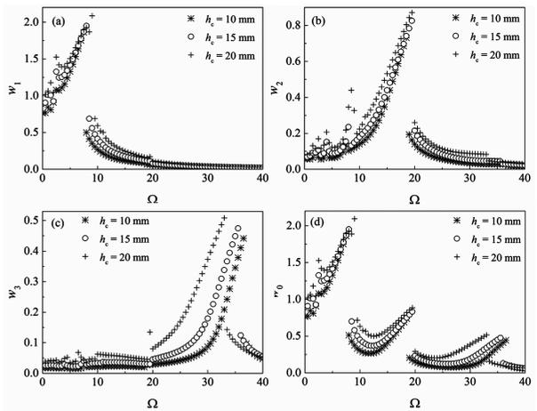
图9 不同的芯层高度下的幅值响应曲线
