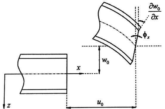
图3 变形前后的夹芯梁几何形状
