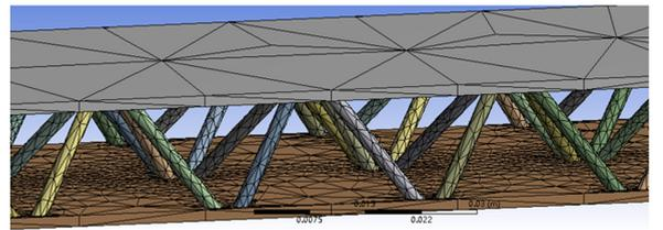
图5 金字塔型点阵夹芯梁的网格划分
