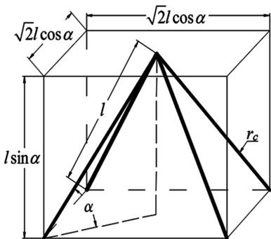
图2 金字塔点阵芯层的晶胞单元
