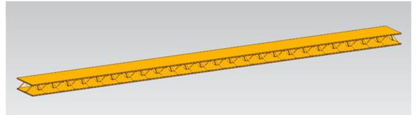
图4 金字塔型点阵夹芯梁模型图
