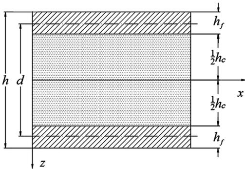
图1 点阵夹芯梁片段示意图
