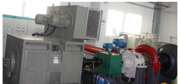
图1 压气机级试验系统实物图
