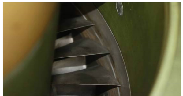
图7 叶片刮壁机匣涂层痕迹
