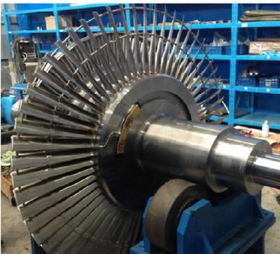
图 2 叶片试验件组件
