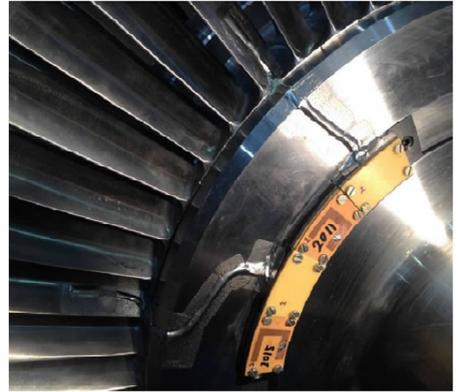
图 3 旋转机械无线电遥测发射装置放大图
