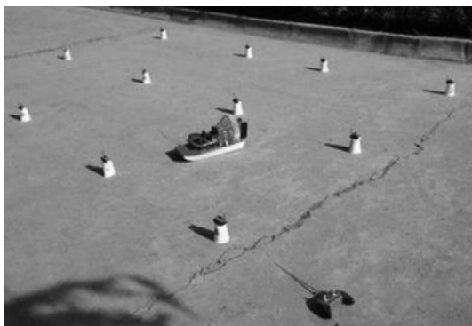
图5 分布式无线传感器节点布置
