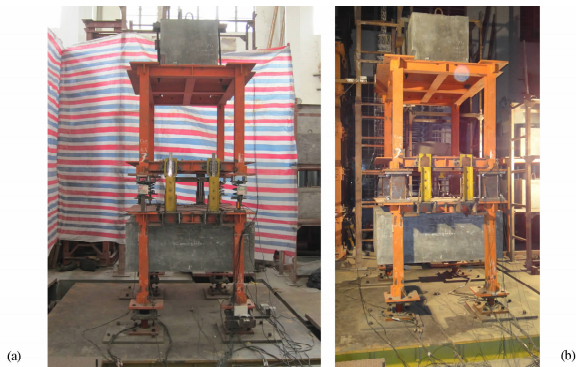
图1 三维隔震结构模型 非隔震结构模型
