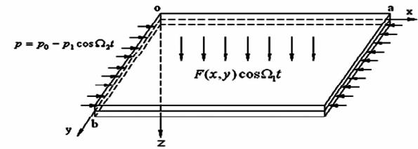
图 1 横向与面内载荷作用下的层合薄板模型
