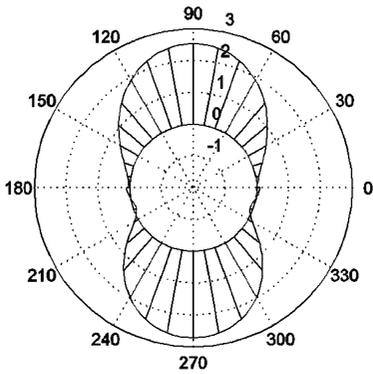
图 3 Mindlin 板两孔孔边动弯矩分布
