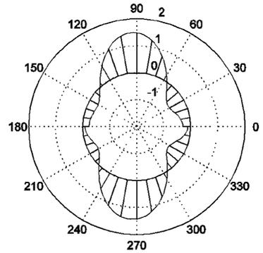
图 12 Mindlin 板两孔孔边动弯矩分布
