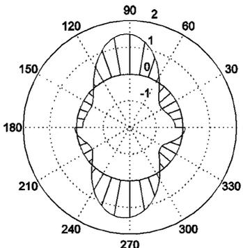
图 11 Mindlin 板两孔孔边动弯矩分布
