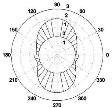
图 6 Mindlin 板两孔孔边动弯矩分布
