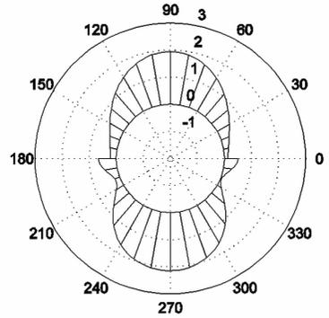
图 5 Mindlin 板两孔孔边动弯矩分布
