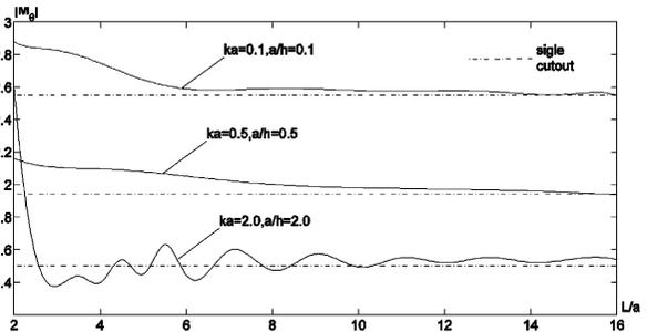
图 13 含双圆孔 Mindlin 板动弯矩集中系数随两孔间距变化规律
