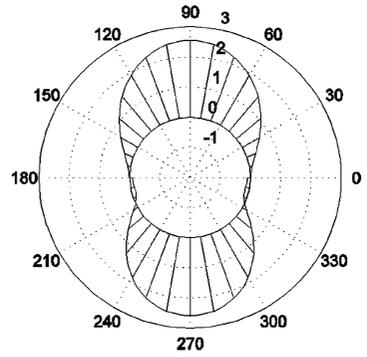
图 4 Mindlin 板两孔孔边动弯矩分布
