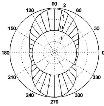
图 8 Mindlin 板两孔孔边动弯矩分布
