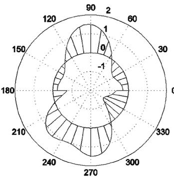
图 10 Mindlin 板两孔孔边动弯矩分布
