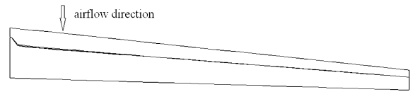
图 6 不同 \theta 时, 一阶扭转模态的节线位置
