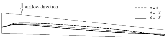
图 5 \theta = 0^\circ, -3^\circ, -5^\circ 时, 水平一弯模态的节线位置
