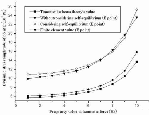
图 5 简支 T 形梁跨中 E 点动应力幅值比较图( $L = 10 \text{ m}$ ) (简谐集中力)
