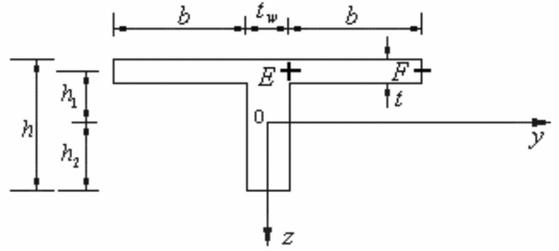
图4 交点 E、F 为所求 T 形梁跨中动应力幅值位置
