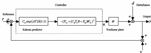
图 2 式(11)控制器的结构图
