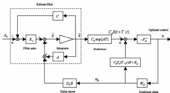
图 3 式(12)控制器的结构图
