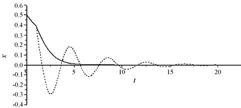
图 3 系统(1)的时间历程,  $k_p = 1.1460$ (实线),  $k_p = 5$ (虚线)
