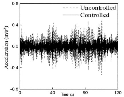
图 3 顶层加速度控制效果曲线
