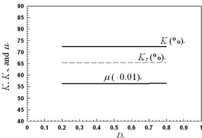
图1 不同参激强度 ( $D_2$ ) 下的控制效果 ( $K$ -无时滞;  $K_r$ -时滞) 与效率 ( $\mu$ )
