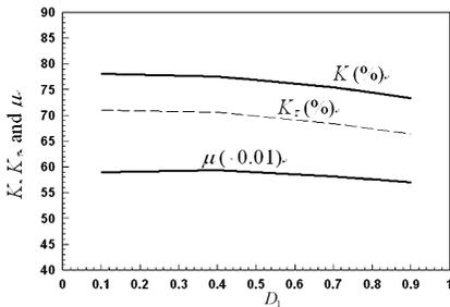
图1 不同外激强度 ( $D_1$ ) 下的控制效果 ( $K$ -无时滞;  $K_r$ -时滞) 与效率 ( $\mu$ )
