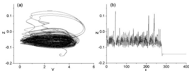
图9  $\tau = 0.013853$  时的混沌危机(a)相图,(b)时间历程
