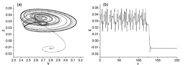
图 5  $\tau = 0.0193$  时的混沌危机 (a) 相图, (b) 时间历程
