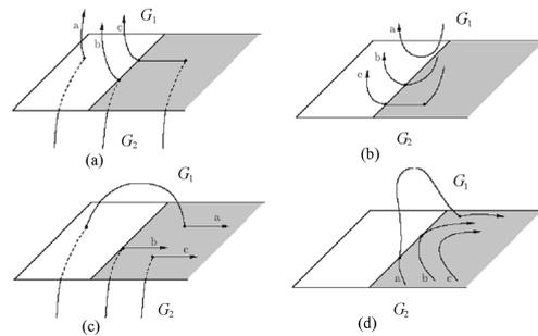
图2 四种可能的余维-1 sliding 分岔:(a)crossing-sliding 分岔;(b)grazing-sliding 分岔;(c)switching-sliding 分岔;(d)adding-sliding 分岔
