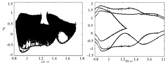
图 9 视  $\omega_1$  为参数物块坐标  $x_1$  的分岔图
