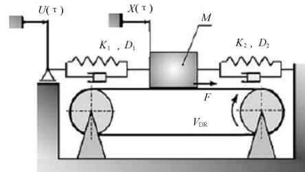
图 1 干摩擦振子模型
