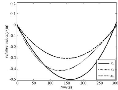
图4 有干扰开环控制时相对速度的变化
