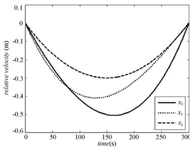
图2 无干扰开环控制时相对速度的变化
