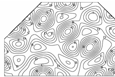
图 7 1000Hz 时声腔的压力虚部的分布
