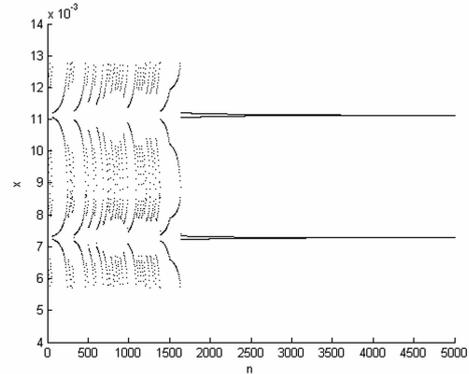
图5 受控系统的稳定到单点碰摩周期2轨道的数值模拟结果
